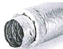
strato di isolante di attenuare ed assorbire il rumore (trasmesso e irradiato) generato nell'impianto di aria primaria. Un film di protezione riveste il materassino isolante per evitarne l'erosione. La coibentazione limita lo scambio termico tra l'aria trasportata e l'ambiente esterno ed evita la formazione di condensa in raffreddamento. La lunghezza del condotto flessibile sarà contenuta entro 5 volte il diametro nominale dello stesso per evitare un eccessivo incremento delle perdite di carico.
